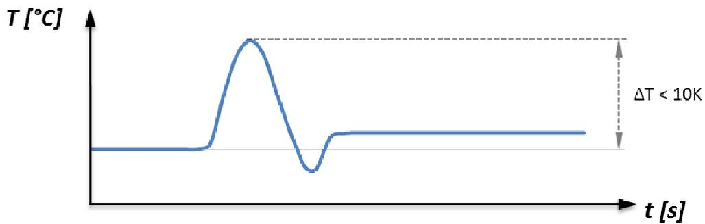
**Abbildung 4:** Maximale Überschwingweite nach einem Lastwechsel ( $< 10\text{K}$ )
