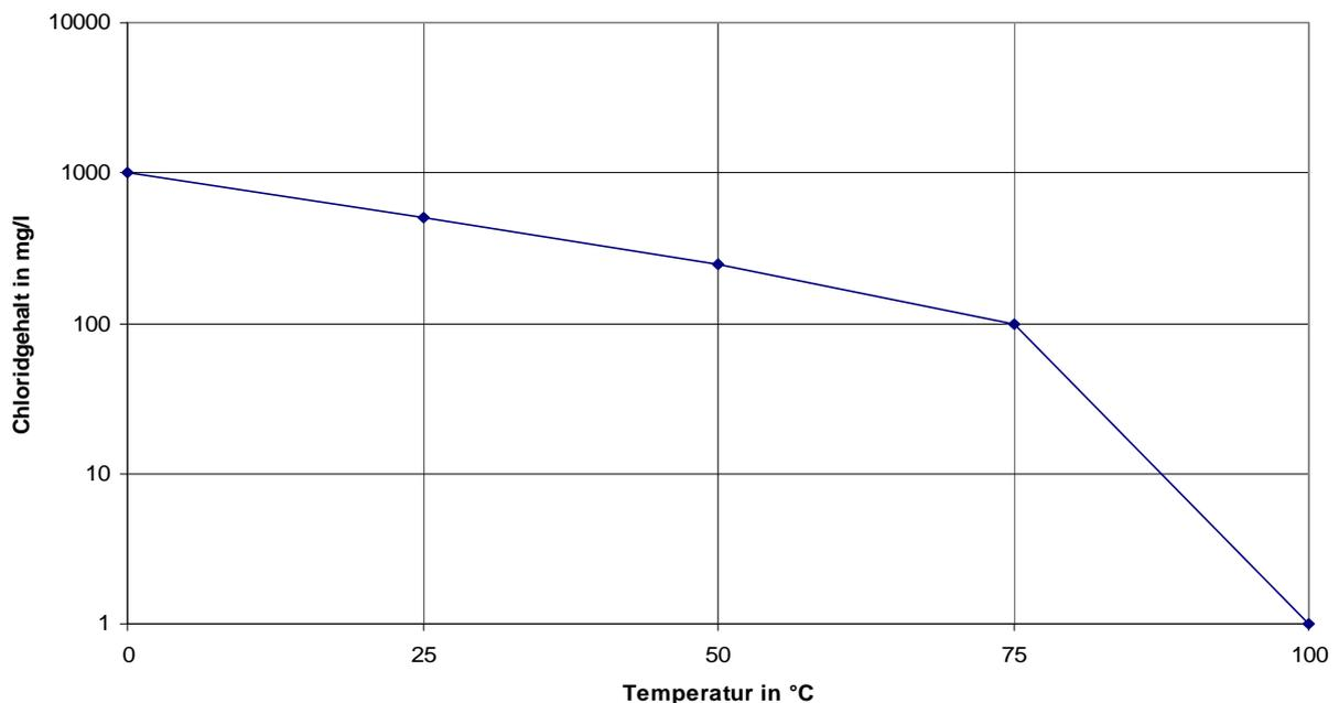
**Abbildung 7:** zulässiger Chloridionengehalt in Abhängigkeit von der Temperatur
