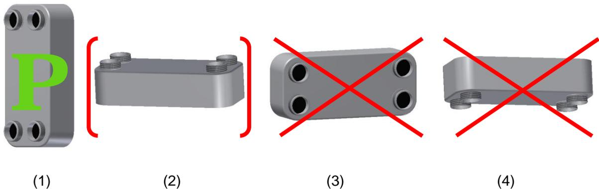
**Abbildung 1:** empfohlene Apparateeinbaulage
