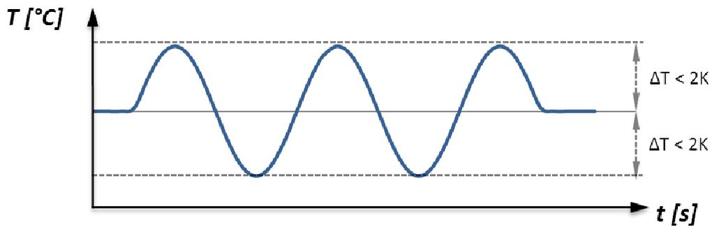
**Abbildung 3:** Maximale permanent auftretende Temperaturschwingungen ( $\pm 2\text{K}$ )
